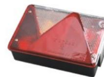
ASPÖCK Multipoint IV Rückleuchte links, mit Blink-, Brems-, Schluss-, Kennzeichen- und Nebenschlusslicht, Dreieckrückstrahler, 5-pol. Bajonettanschluss, H: 136 x B: 200 x T: 56 mm
