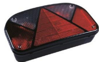
ASPÖCK Multipoint II Rückleuchte links, mit Blink-, Brems-, Schluss-, Kennzeichen- und Nebenschlusslicht, Dreieckrückstrahler, 5-pol. Bajonettanschluss, H: 140 x B: 240 x T: 52 mm
