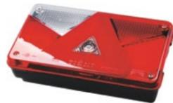
ASPÖCK Multipoint V Rückleuchte LED links, mit Blink-, Brems-, Schluss-, Kennzeichen- und Nebelschlusslicht, Dreieckrückstrahler, 5-pol. Bajonettanschluss, H: 140 x B: 238 x T: 55 mm
