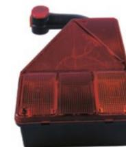
ASPÖCK Earpoint I Rückleuchte links, mit Blink-, Brems-, Schluss- und Nebelschlusslicht, Umrissleuchte, Dreieckrückstrahler, 5-pol. Bajonettanschluss, H: 328 x B: 179 x T: 84 mm
