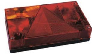
ASPÖCK Multipoint I Rückleuchte links, mit Blink-, Brems-, Schluss-, Kennzeichen- und Nebenschlusslicht, Dreieckrückstrahler, 5-pol. Bajonettanschluss, H: 140 x B: 240 x T: 52 mm
