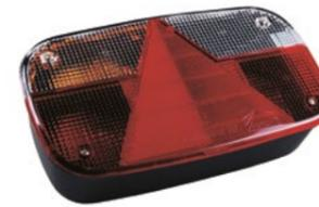
ASPÖCK Multipoint III Rückleuchte links, mit Blink-, Brems-, Schluss-, Kennzeichen- und Nebenschlusslicht, Dreieckrückstrahler, 5-pol. Bajonettanschluss, H: 138 x B: 244 x T: 60 mm
